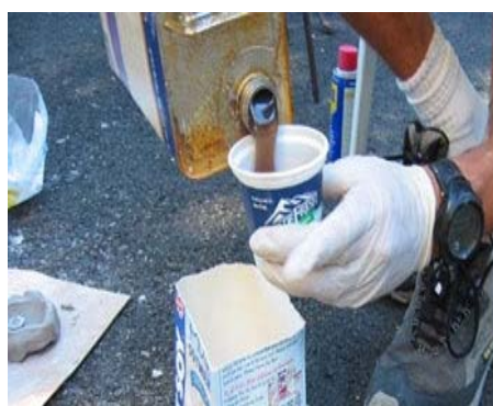
Sl.4. Miješanje epoksi smole sa očvršćivačem, sredstvom kojeg stvrdnjava. Pored omjera komponenti, brzina stvrdnjavanja ovisi i o temperaturi prostorije
